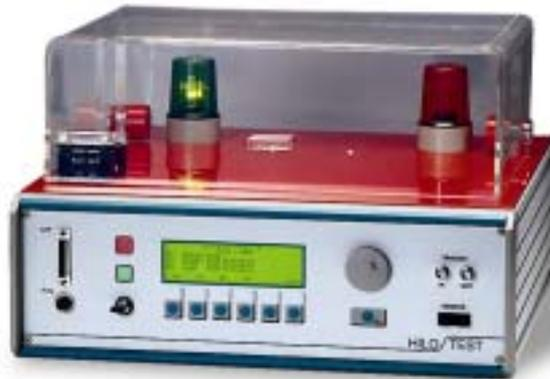
高压脉冲发生器 IPG 809 用于对 X-、Y-电容器的介电测试，产生满足 IEC 384-14、EN 132400、VDE 0565 (1999) 等要求的、高达 8kV 的标准脉冲电压  $1.2/50 \mu s \pm 30\%$ 。
